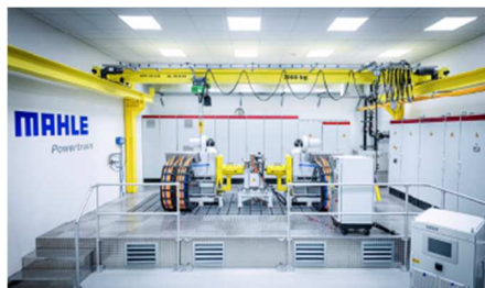
Fokus auf Elektromobilität: MAHLE Prüfstand für elektrische Antriebsachsen in Fellbach bei Stuttgart.
