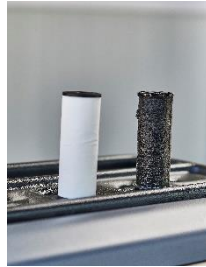
Der Vergleich zwischen altem und neuem Filter zeigt, wie notwendig ein Getriebeölwechsel ist.
