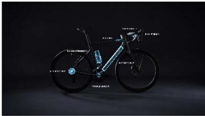
Optisch ansprechend: Batterie und Antrieb sind im Rahmen integriert.
